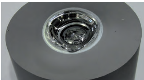
Erkalteter Si-Einkristallblock mit erstarrtem Schmelzsumpf nach der Verdampfung
